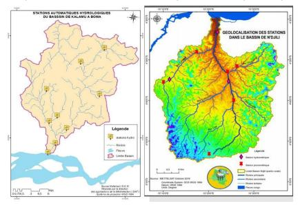
Chaque bassin est équipé de 3 limnimètres + 5-7 pluviomètres, le modèle GR4H développé par BRLi fournit des prévisions des zones inondées.
